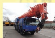
Liebherr LTM 1130-5.1 130 t YOM 2007
