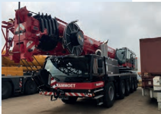
Mammoet's new Liebherr LTM 1130-5.1
