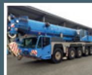
DEMAG AC200-1, 200 Ton Capacity
